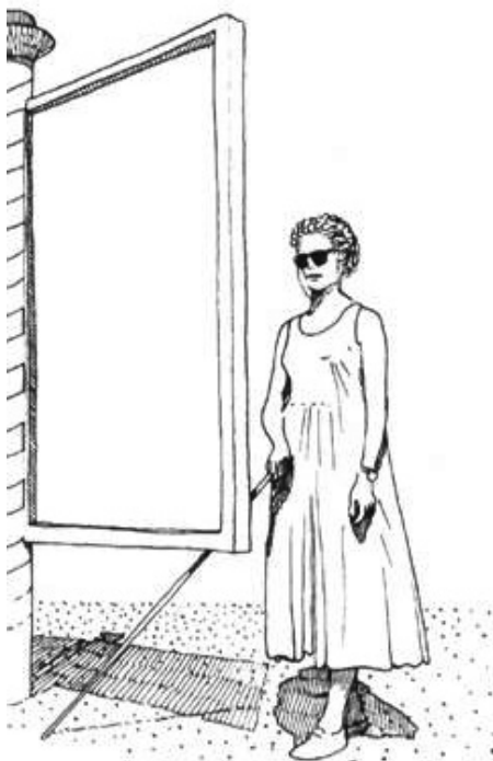
Elemento voladizo que constituye un riesgo para personas con discapacidad visual
